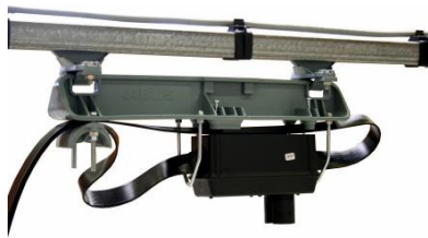
Det rörliga manöverdonets styrvagn vid traverskabel
